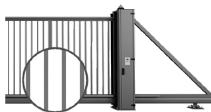
Vulling in de vorm van gesloten profielen 30x18mm gelast aan de constructie.
