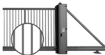
Buisvormige vulling ø 25mm – gelast aan de constructie.
