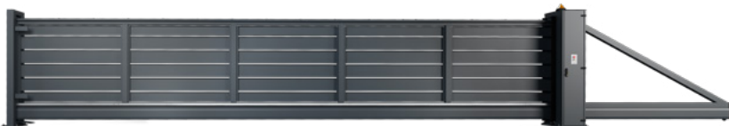
Horizontale vulling van 1 [mm] dikke metalen plaat met speling tussen de panelen 20 [mm] (patroon van vulling)
