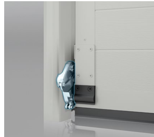
Veiligheidsrem die ervoor zorgt dat het poortblad niet valt in geval van kabelbreuk
