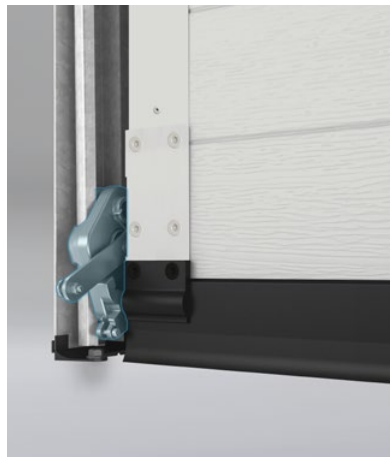
Veiligheidsrem die ervoor zorgt dat het deurblad niet valt in geval van kabelbreuk
